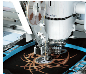
■ YN Sequin Device ● 圆头珠片装置
