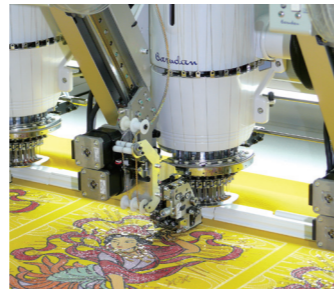
■ YN Twin Sequin Device ● 圆头双珠片装置
